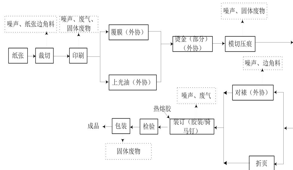
图 2-1 册子生产工艺及产污节点示意图
