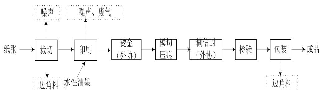
图 2-3 信封生产工艺及产污节点示意图
