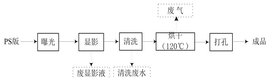
图 2-6 制版工艺及产污节点示意图
