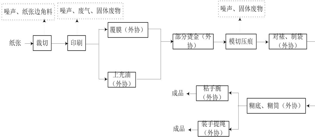
图 2-4 纸袋生产工艺及产污节点示意图
