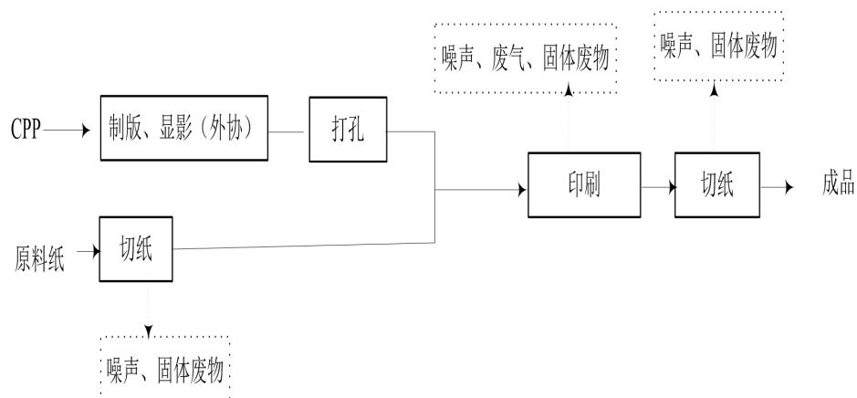
图 2-7 原有项目其他印刷品生产工艺流程及产污点图
