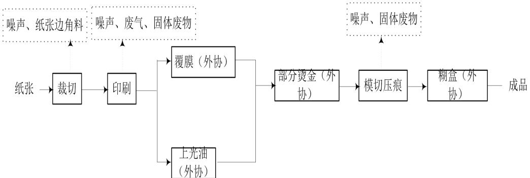
图 2-5 纸盒生产工艺及产污节点示意图
