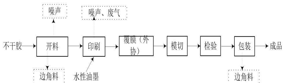
图 2-2 不干胶生产工艺及产污节点示意图
